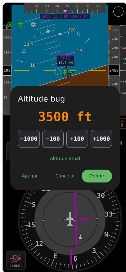
Ajustando o altitude bug para 3500 ft.
