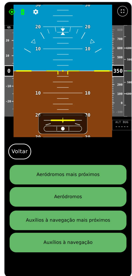
O menu Direct-To. Voltar retorna ao HSI.
